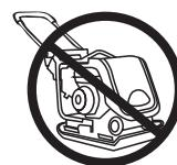
UNDER NO CIRCUMSTANCES SHOULD A MECHANICAL COMPACTOR BE USED DIRECTLY ON THE SLAB SURFACE.
